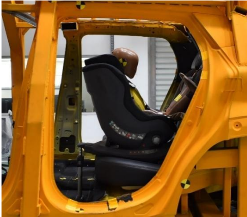
Figure 6. Original testing environment Q3 backward installation test 图 6. 原测试环境 Q3 后向安装试验
