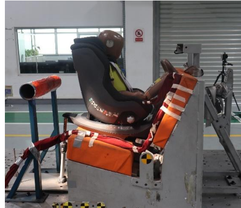
Figure 7. New testing environment Q3 backward installation test 图 7. 新测试环境 Q3 后向安装试验
