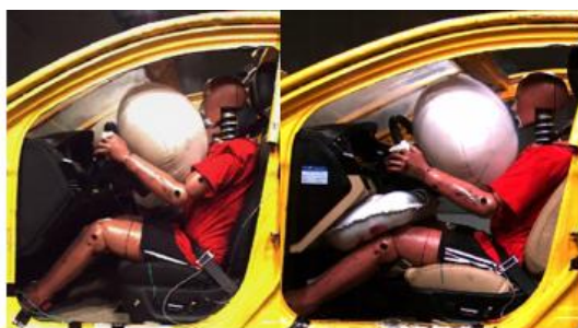
图 9 膝部气囊对比试验 40 ms 时刻录像截屏
