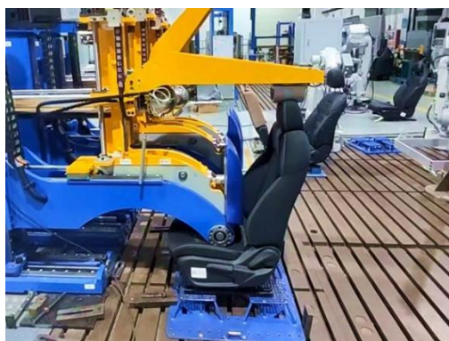
图 4 头枕高度保持测试
