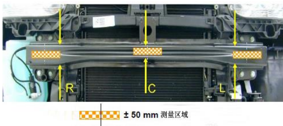
图 3. 防撞横梁测量位置示意图[7]
