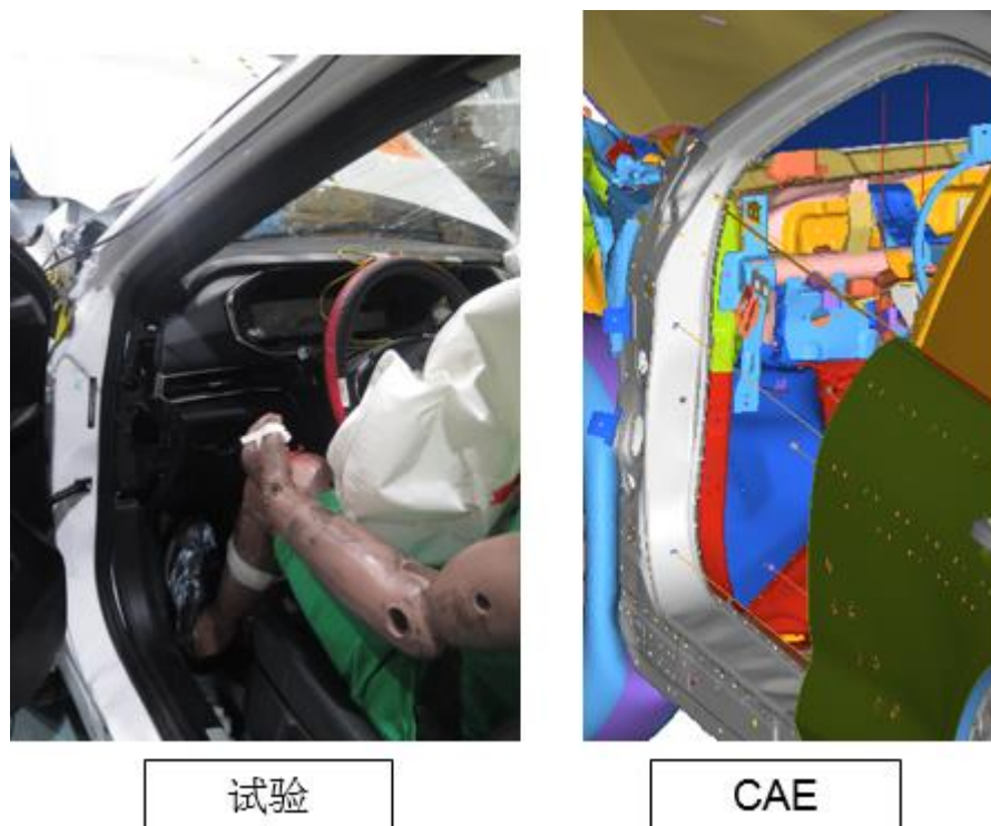
图 5. 试验与 CAE 对比图（A 柱）
