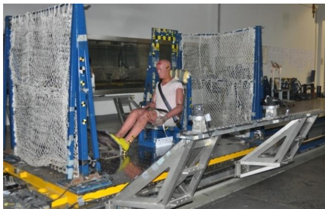
Figure2 Simulation test of dummy trolley 图 2 假人台车模拟试验
