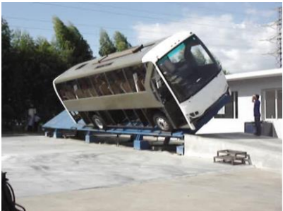
图 9 客车静态侧翻稳定角试验
