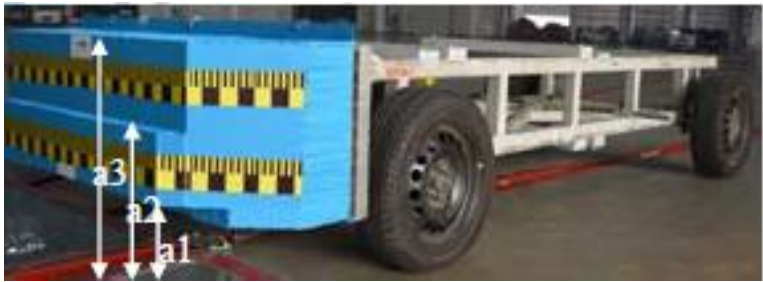
图 2. 实验壁障示意图
