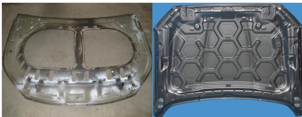
(a) 中间位置弱化的发动机盖内板
