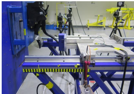
Figure 2. Clamp of accelerator pedal impact test 图 2. 加速踏板的冲击试验工装
