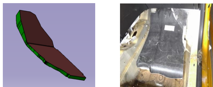
(a) 副驾 EVA+PU 发泡方案数据 (b) 副驾 EVA+PU 发泡手工样件
