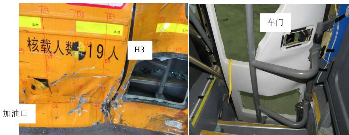
图 18 校车的前门变形和油箱加油口位置
