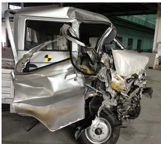
图 12 轻卡右前门脱落
