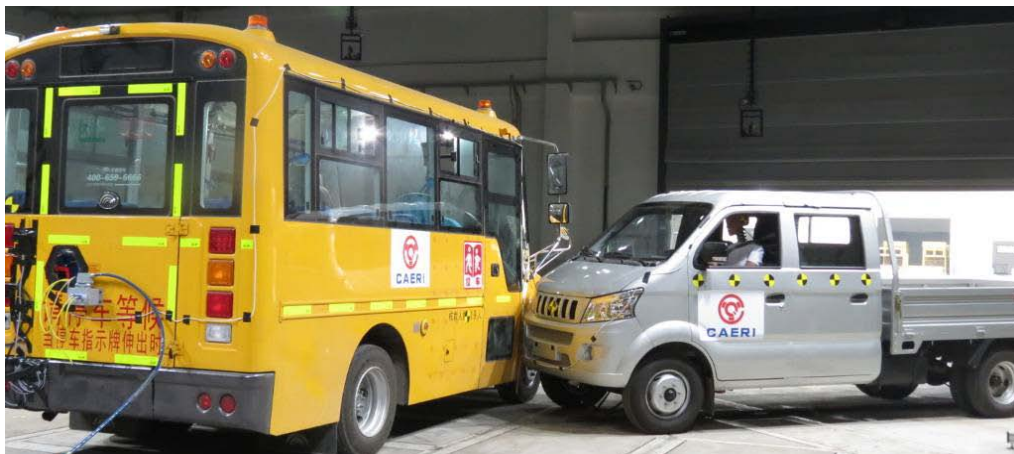
图 1 轻卡对校车 45 度角对撞的试验设置
