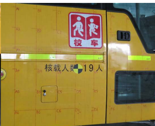
图 3 校车侧面侵入量的位置
