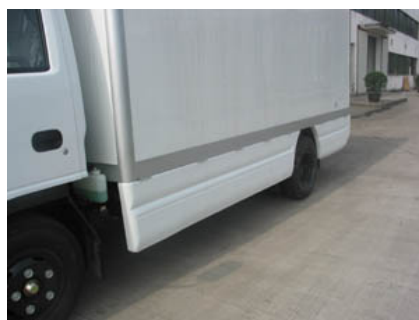
图2. 连续平面式侧面防护装置
