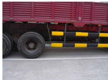
图1. 非连续平面式侧面防护装置
