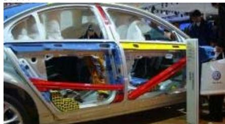
图5 有防撞梁设计的某车型
