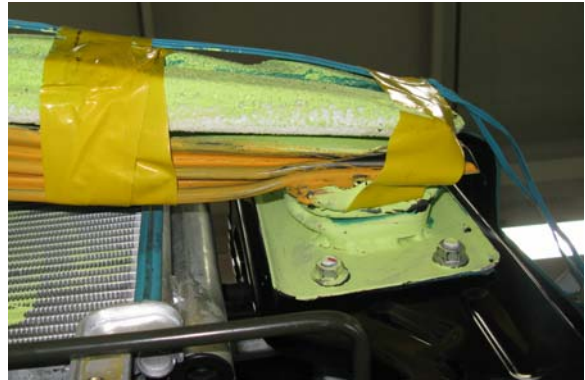
图 4.5 优化设计后的实车碰撞受撞区变形情况
