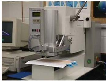
图 10 气袋布气密性动态测试设备
