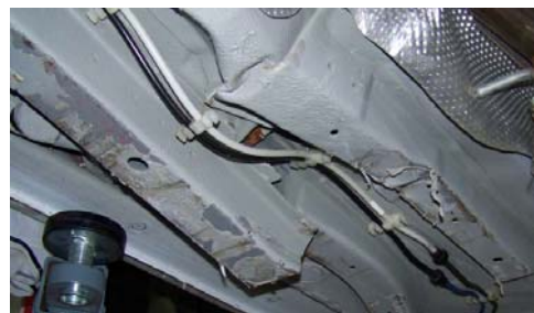
(b) 试验一底板纵梁变形
