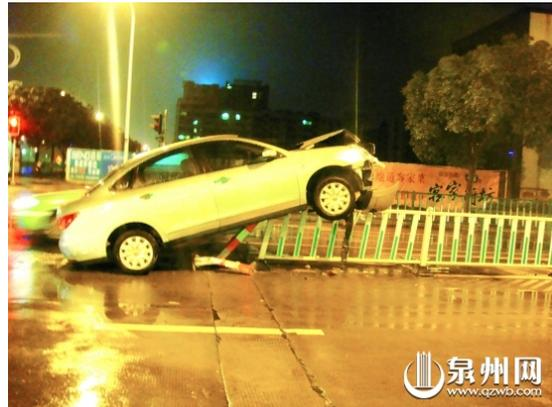
图 8 某轿车撞击护栏端头后的损伤情况
