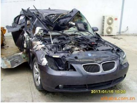
图 5 某轿车钻入卡车尾部后损伤情况
