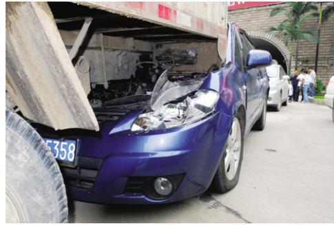
图 6 高速刮擦事故气囊没有起爆
