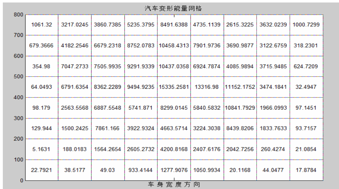
图 8 基于测力墙的变形能量网格
