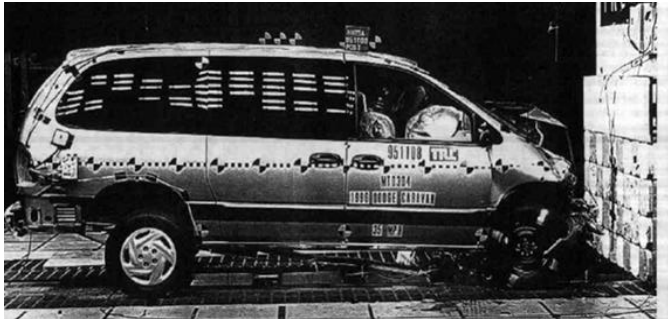
图 6 正面测力墙全宽碰撞
