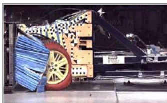
图9 子结构滑车试验
