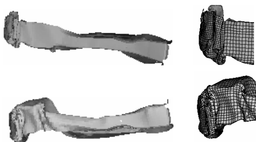
图10 Case5 前纵梁变形图
