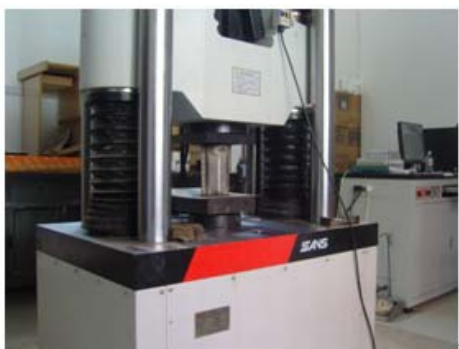
图 5 准静态压溃试验
