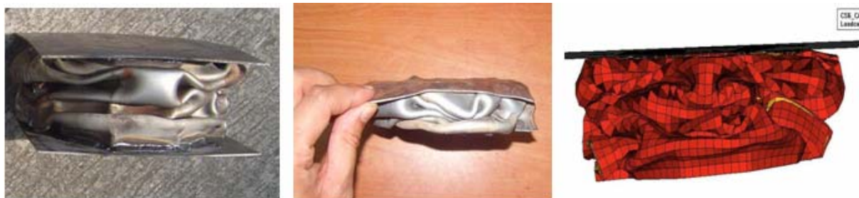
图 6 准静态压溃试验、台车试验与仿真碰撞结果对比
