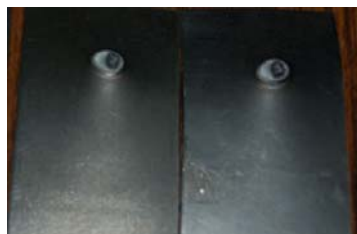
图 1.界面断裂失效模式
