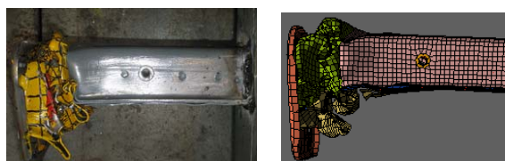
图 12 前纵梁变形的俯视图
