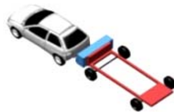
(2) FMVSS 301 整车后部碰撞模拟工况
