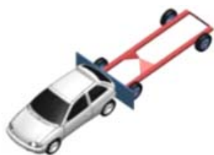
(1) GB 20072 整车后部碰撞模拟工况
