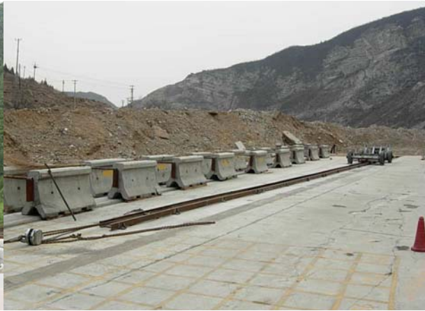
图 3 模型试验跑道、导轨及被加速台车
