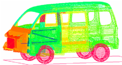
图 8 改进方案车体有限元模型
