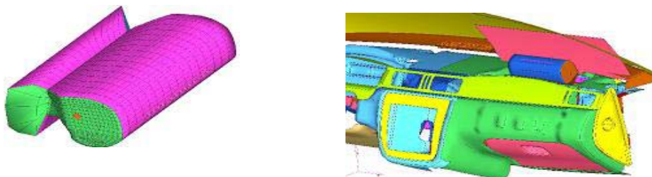
图 4 副驾驶安全气囊有限元模型
